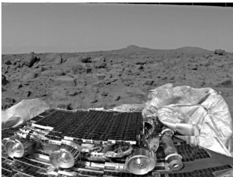
Das Marsmobil Sojourner, noch zusammengeklappt, bei der Ausfahrt aus dem Landemodul, der Airbag versperrt noch den Weg.
