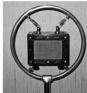
Abb. 1: Kohlemikrofon AEG M8 aus dem Jahr 1929 von AEG mit Federaufhängung zum Schutz vor Trittschallübertragung (Foto: Th. Krause, HS Heilbronn)
