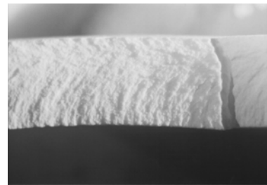
Bild 2: Seitenansicht eines Risses unter dem Mikroskop
