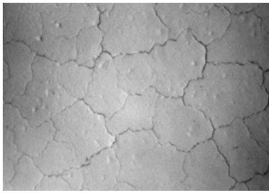
Bild 3: Durch Spannungsgradienten hergerufene "Inselrisse"
