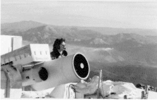
Ein Netzwerk von Laser Ranging Stationen vermißt die Bahnen der LAGEOS-Satelliten auf besser als 1 cm.
