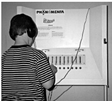
Exponat "Hörkurve": Nach der Durchführung des Experiments zeigt die Stellung der Schieberegler recht genau das Hörvermögen über den gesamten Frequenzbereich.
