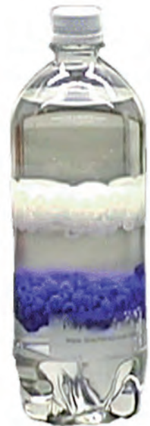
Abb. 2: Die dunklen Kunststoffstücke sinken zu Boden, die hellen steigen auf.
