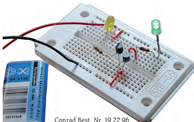
Abbildung: LED als Lichtsensor: Der Sperrstrom der linken LED schaltet die rechte LED
