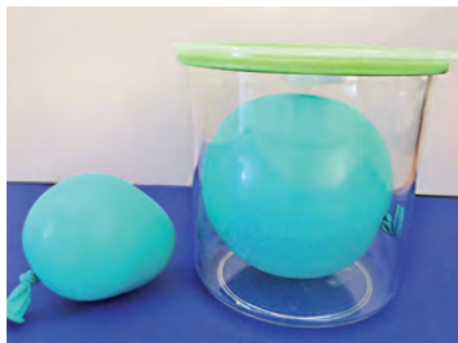
Abb. 1: links: Ausgangsgröße des Luftballons rechts: Luftballon nach dem Absaugen der Luft im Vakuumierset
