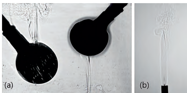
Abb. 5: Konvektion sichtbar gemacht durch Schattenprojektion mit einer Halogenlampe ohne Kondensator. Links: Zwei Glaskolben mit heißem bzw. kaltem Wasser. Rechts: Konvektion in Luft oberhalb einer Kerze.
