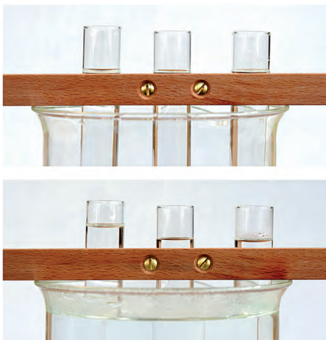
Abb. 4: Thermische Ausdehnung von Flüssigkeiten im Reagenzglas. Oben: Bei Raumtemperatur ist der Meniskus jeweils an der Oberkante der Holzleiste. Unten: Nach Befüllung des großen Bechers mit 1 Liter Wasser von 75°C steigt die Flüssigkeit innerhalb von zwei Minuten auf die neue Gleichgewichtslage. Die Flüssigkeiten sind, von links nach rechts, Ethanol, Glycerin und Wasser. Das Wasser dehnt sich um 2%. Die Notwendigkeit des Volumenausgleiches in einer Heizungsanlage oder beim Autokühler wird unmittelbar einsichtig.
