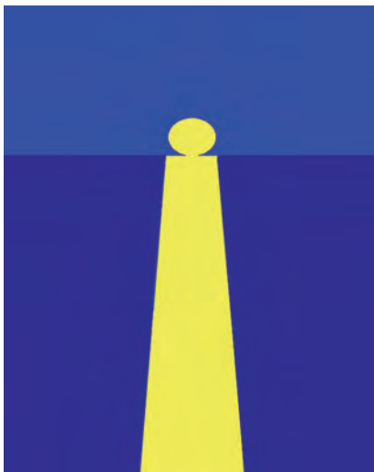
Abb. 6: Simulation eines Sonnenunterganges am Meer mit realistischen Parametern ( R = 6370 \text{ km} , T = 273 \text{ K} , \alpha_{\text{max}} = 5^\circ ). Geometrisch befindet sich die Sonne bereits 0.4^\circ unter dem Horizont.
