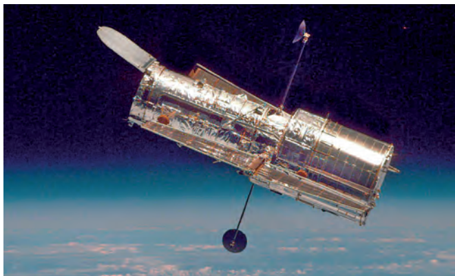
Abb. 6: Das Weltraumteleskop Hubble-Weltraumteleskop, aufgenommen während der zweiten Servicemission 1997. Das Teleskop beobachtet das Weltall in einer Höhe von 569 Kilometern und ist somit völlig unbeeinträchtigt von der Erdatmosphäre. (Bild: NASA)
