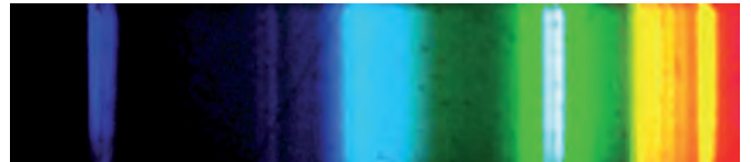
Abb. 2: Spektrum einer Energiesparlampe. Im Außenbereich eingesetzte Leuchtstoffröhren haben sehr ähnliche Spektren.
