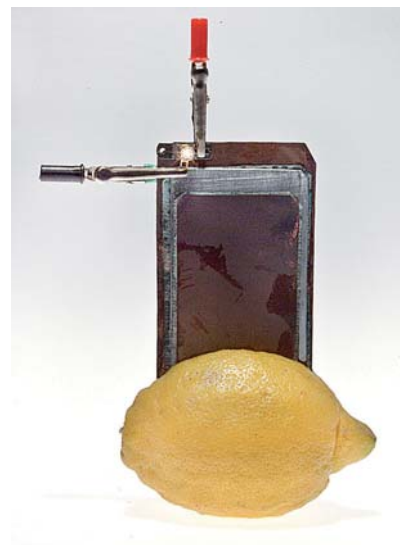
Abb. 13: Zitronenbatterie mit einem leuchtenden Mini-Lämpchen ( U = 0,785 \text{ V} ; I = 68,6 \text{ mA} )
