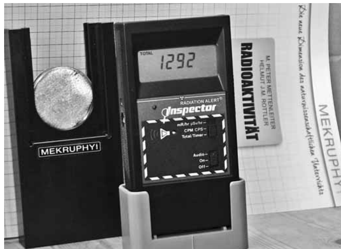
Das Strahlenmessgerät INSPEKTOR und der Glühstrumpf im Plastikdöschen in der praktischen Halterung.
