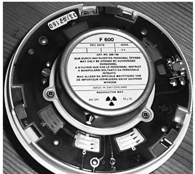
foto: Rauchmelder Ionisationsrauchmelder enthalten Americium 241 ( \alpha -Strahler, 432,6 Jahre Halbwertszeit)
