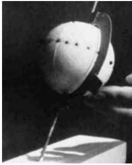
Abb. 8: Kugelsonnenuhr mit beweglichem Zeiger (Stundenmarken am Äquator)
