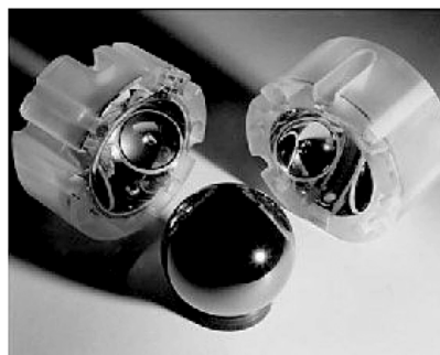
Abb. 3: Gyroskope in Quarzgehäuse
