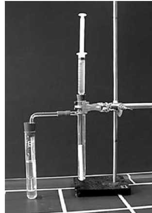
Nachweis Kalklauge Beginn
