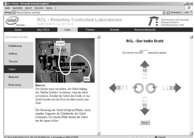
Abb. 6: RCL „Heißer Draht“ als Schülerprojekt mit Fischertechnik©-Bausatz: Ein Beispiel dafür, wie Schüler selbstständig im Rahmen eines Projekts ihren „eigenen“ Roboter für bestimmte selbst gewählte Anwendungen - wie z. B. zum Steuern und Regeln, als Fließbandroboter - als RCL aufbauen können. Im Bild links oben ist das Schema des Spiels „Heißer Draht“ dargestellt. Das Bild rechts oben zeigt die Realisation des Spiels mit Hilfe eines Fischertechnik Bausatzes; anstatt Drahtschlinge wurde hier eine Drahtgabel verwendet.
