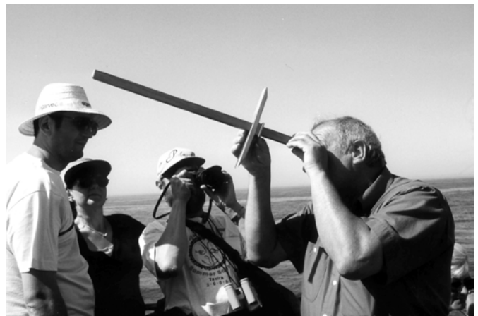
Abb. 2: Bestimmung der Sonnenhöhe mit dem Jakobsstab
