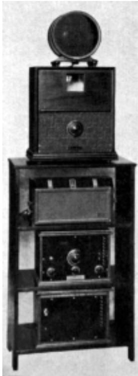
Bild 8: Fernsehempfänger der Telehor A.G. mit zusätzlichem Rundfunkgerät
