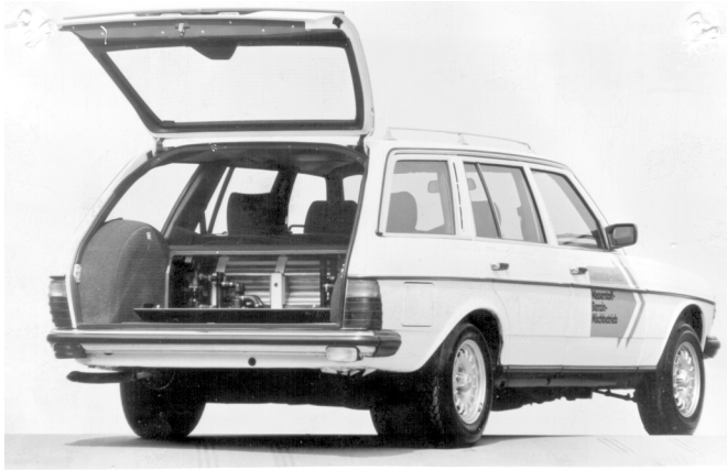
Abb. 5: Weltweit erstes Fahrzeug mit Wasserstoff/ Benzin Betrieb und Hydridspeicher (Mercedes Benz PKW; 1975)
