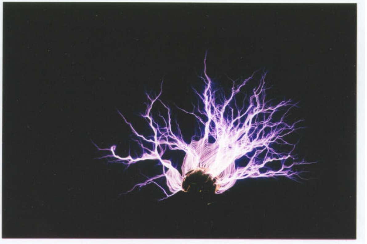
Abbildung 8: Versuch Blitzentladung mit Tesla Spule
